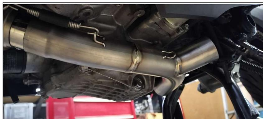
7. R リヤパイプをセンターパイプに取付け、ステー部を付属の M8x20 ボルトにてフレームへ仮止めします。マフラスプリングを取付けます。
