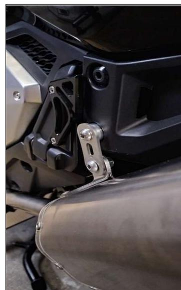
10. サイレンサーの取付けが終わりましたら仮締状態のフロントパイプのマフラーフランジナットを締め付け、右リヤパイプのフレームマウントステーのボルトを締め付けて下さい。
