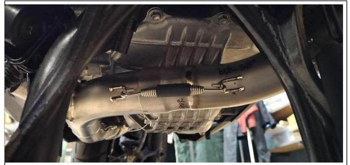
8. L リヤアンダーカウルを付属品に交換し、L リヤパイプをセンターパイプに取付け、マフラスプリングを取り付けます。
